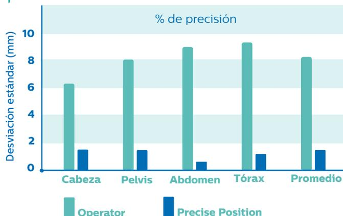
**Figura 7** Consistencia de la planificación vertical según la anatomía del objetivo, que muestra la desviación estándar para los operadores solos en comparación con el uso de Precise Position.
